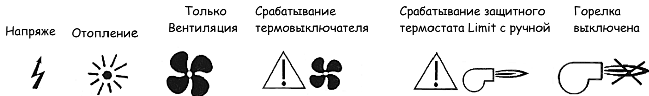
Рисунок 1 Графические символы, имеющиеся на щитке управления и на устройствах аварийной сигнализации.
